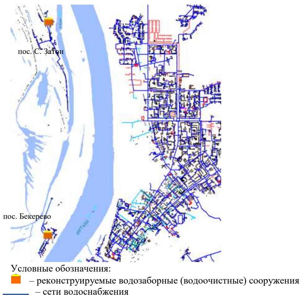
Рисунок 14. Перспективное размещения объектов системы водоснабжения ТО Левобережье (вариант 1)
