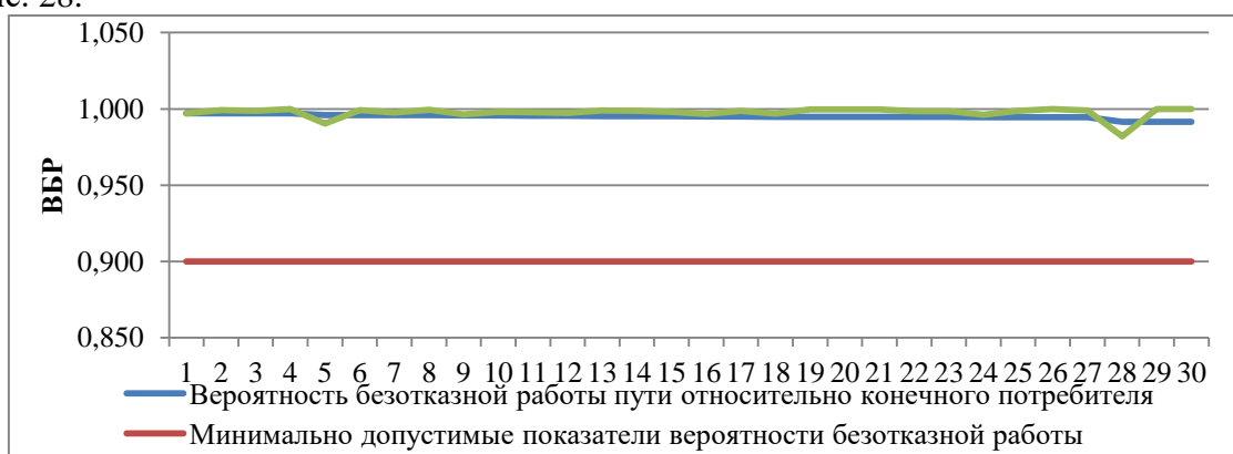
Рисунок 30. ВБР относительно участка тепловой сети от камеры «Вывод - Котельная № 5» до потребителя по ул. Семакова, 58
