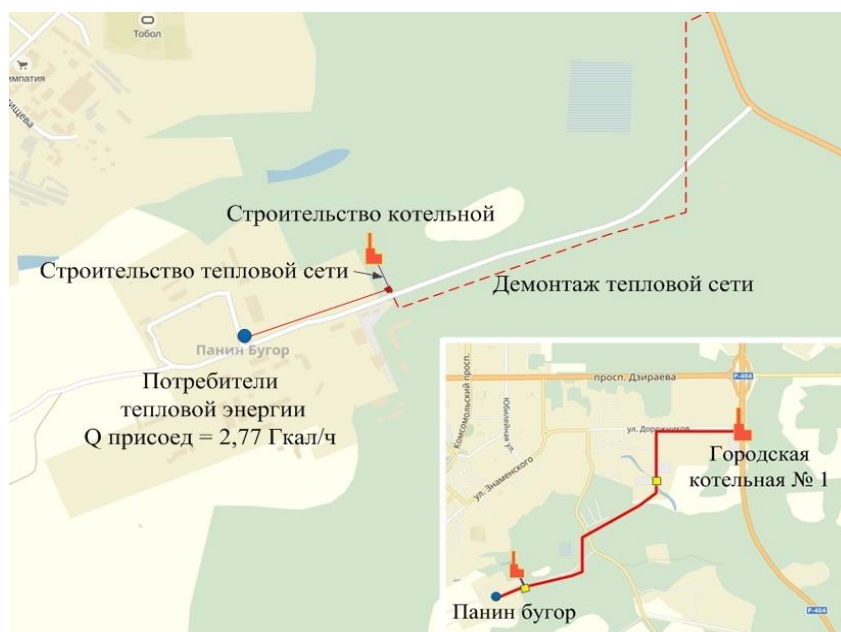
Рисунок 4. Теплоснабжение мкрн. Панин бугор
